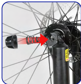
Húzza meg a rugót és az anyát a csavarral, de ne teljes erővel!
