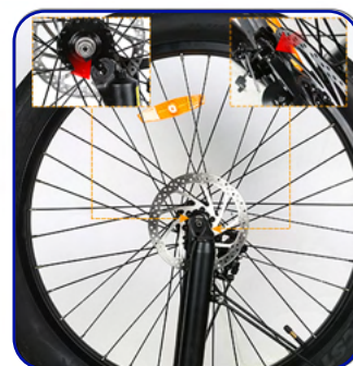
Szerelje fel az kereket, ügyelve arra, hogy a tárcsafék arra az oldalra essen, ahol a fékpoék is találhatóak!
