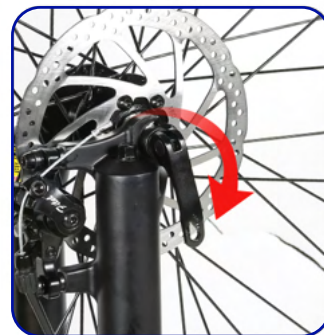
Zárja le a gyorskioldó fogantyút, és ezzel elkészült az első kerék felszerelése!
