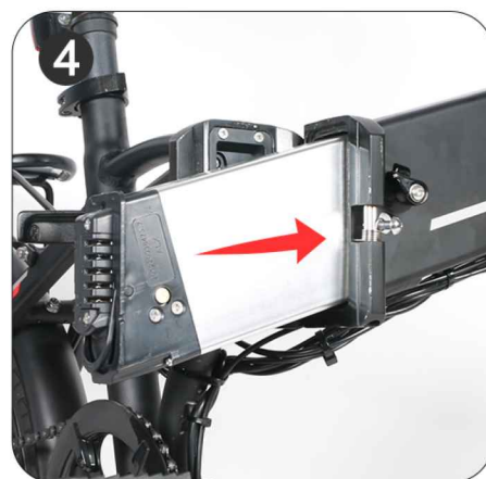
4 Helyezze be az akkumulátort a tartóba úgy, hogy a negatív pólus legyen felül, a pozitív pólus pedig alul!
