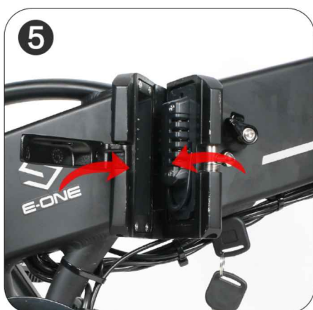
5 Helyezze be a kulcsot a váz alján a kulcslyukba, forgassa el az óramutató járásával megegyező irányba az akkumulátor rögzítéséhez, majd hajtsa össze a vázat!
